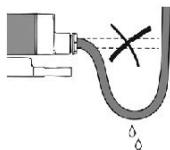
**Внимание!** Вода не должна проникать в клеммную коробку. Кабель необходимо монтировать с образованием петли для стекания капель жидкости.
