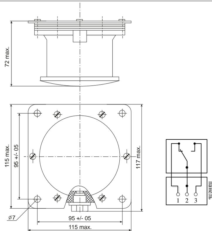
Рис 1. Габаритные и установочные размеры; схема электрическая принципиальная
