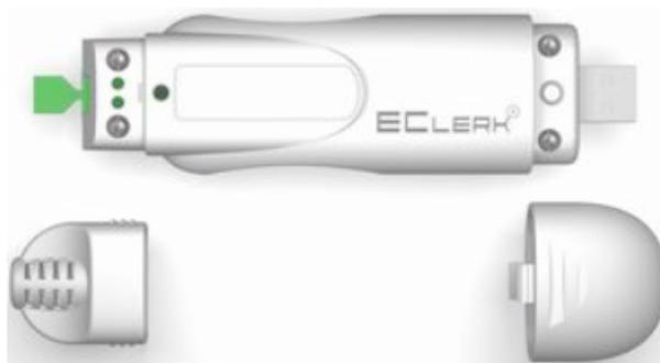
С другой стороны корпуса под защитным колпачком имеется USB-разъём для подключения логгера температуры и влажности EClerk-M-RHT к персональному компьютеру и кнопка для выбора режима работы регистратора.
